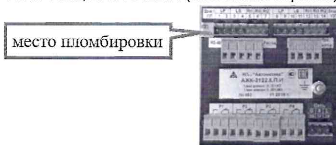
Рис. 9 – Схема пломбирования анализаторов жидкости кондуктометрических АЖК-3122, АЖК-3122.П (щитовой вариант)
