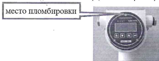
Рис. 10 – Схема пломбирования анализаторов жидкости кондуктометрических АЖК-3110, АЖК-3130
