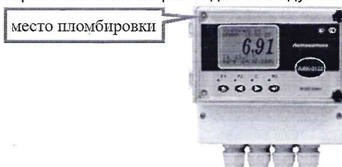
Рис. 8 – Схема пломбирования анализаторов жидкости кондуктометрических АЖК-3122, АЖК-3122.П (настенный вариант)
