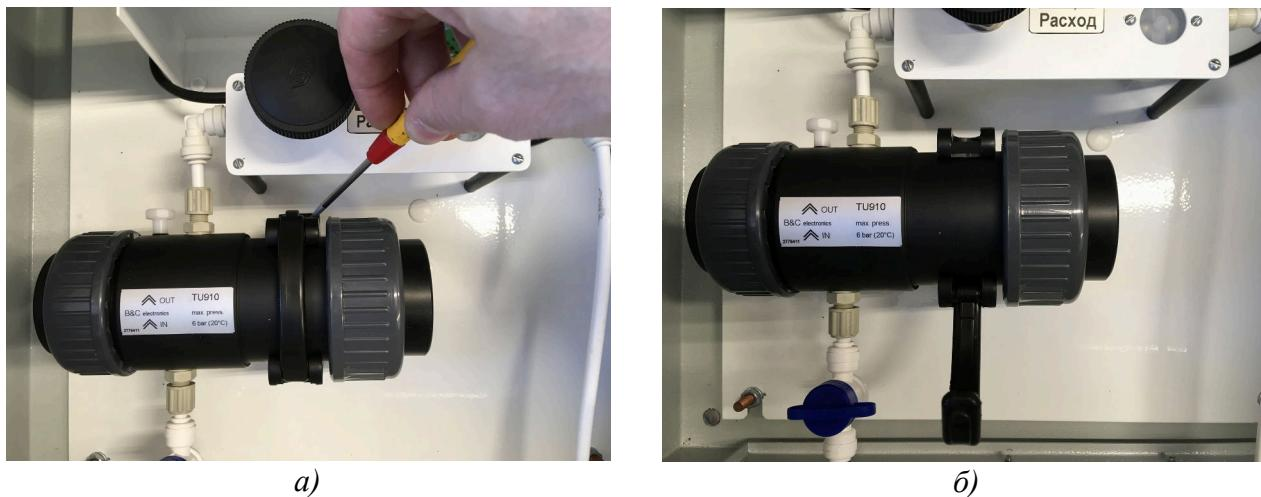
Рисунок 6 - Снятие ячейки с гидропанели
