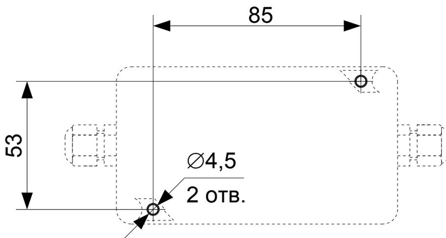
Рисунок А.1 - Габаритные и монтажные размеры НПТ-2.6Д, НПТ-2.7Д
