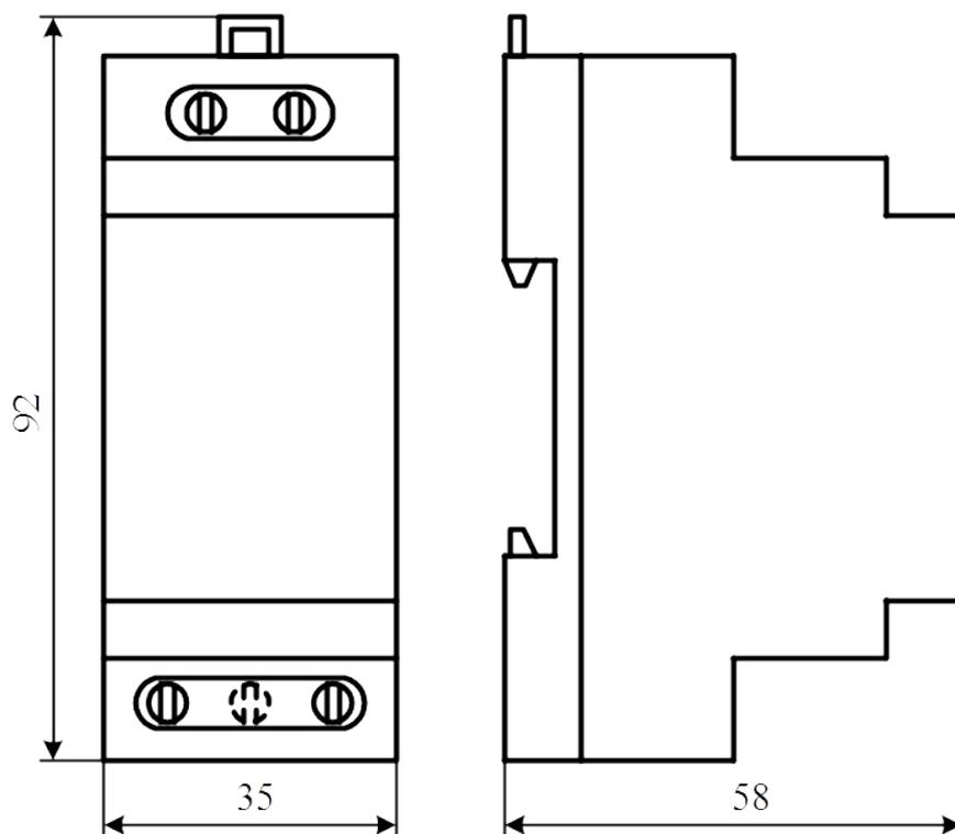
Рисунок А.2 - Габаритные и монтажные размеры НПТ-2.6Р, НПТ-2.7Р
