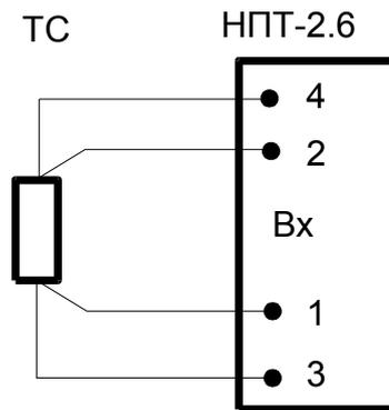
Рисунок Б.3 - Четырёхпроводное подключение ТС к НПТ-2.6
