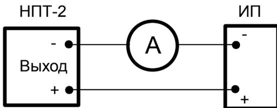
Рисунок Б.4 - Подключение ИП
