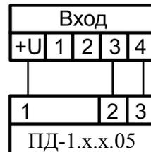
Подключение сопротивления и термометра сопротивления:
