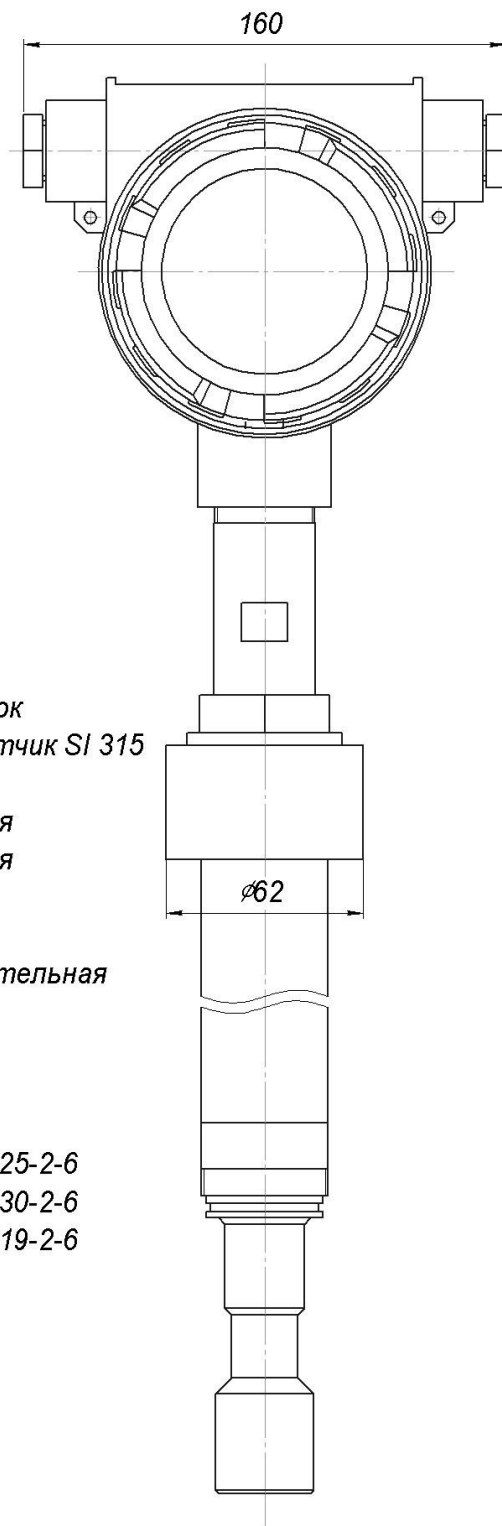
Рисунок А.5 - Габаритные и монтажные размеры анализатора в корпусе «И» с погружной арматурой (с индуктивным датчиком SI 315)
