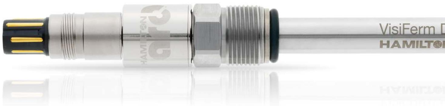
VisiFerm DO - это первый оптический кислородный датчик со встроенной оптической электроникой, имеющий полную функциональность измерительного устройства с самодиагностикой. Он рассчитан на стерилизацию паром, автоклавирование и CIP-мойку. VisiFerm требует меньше обслуживания, чем классический кислородный датчик, поскольку он не имеет механически чувствительной мембранны или коррозионного электролита.
