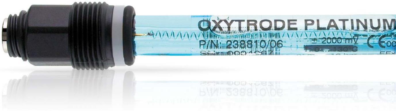
Не требующие технического обслуживания датчики OxyTrode Pt разработаны для того, чтобы применяться в процессах химической промышленности и при очистке сточных вод. Три высокоэффективных керамических диафрагмы снижают влияние потока жидкости при монтаже в трубе.
