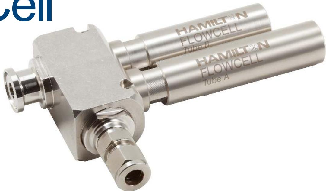
ПротОчные ячейки Flowcell от Hamilton предназначены для измерения одного или двух параметров одновременно. Возможные комбинации датчиков: pH/DO и pH/Проводимость. Измерение производится в байпасной линии, если монтаж в основную трубу невозможен из-за малых размеров трубы. Области применения - биотехнология, водоподготовка и электростанции, где надежные измерения должны проводиться в ионно-слабых (слабо проводящих) средах. Доступны два разных размера протOчной ячейки.
