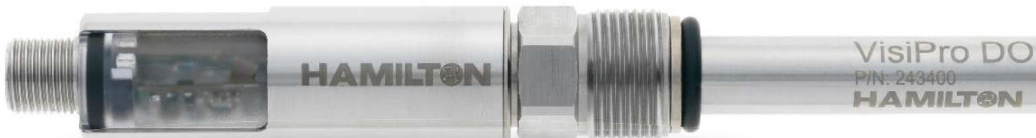
VisiPro DO - это оптический датчик растворённого кислорода (DO) для использования во взрывоопасной среде. Оптическая технология VisiPro DO улучшает метрологические характеристики и упрощает техническое обслуживание. Улучшения по сравнению с обычными электрохимическими (амперометрическими) датчиками включают в себя независимость от потока, быстрый запуск без затрат времени на поляризацию и упрощенное обслуживание.
