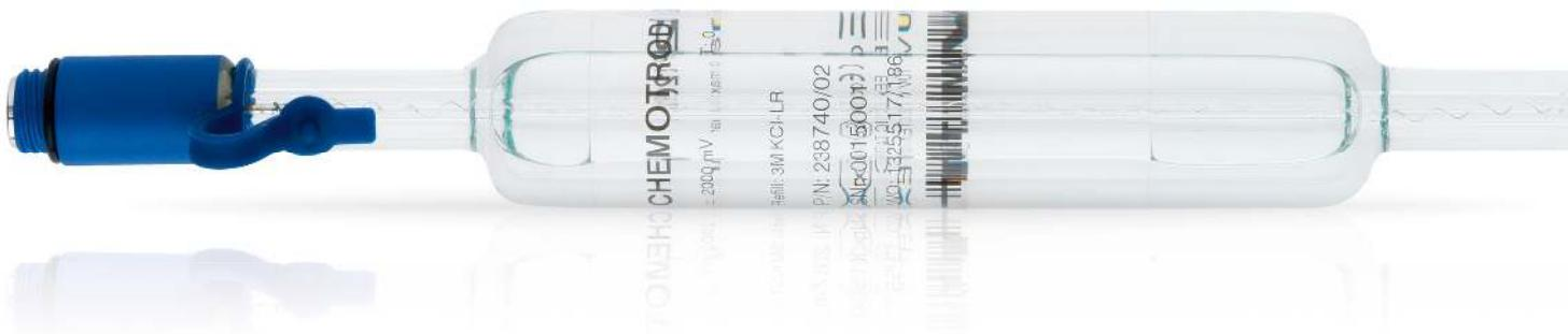
ORP ChemoTrode является самым надежным датчиком для измерения окислительно-восстановительного потенциала в сложных применениях в фармацевтической и химической промышленности. ChemoTrode имеет отверстие для заправки, которое позволяет заправлять электролит и повышать давление эталонного электролита системы сравнения. Его картридж системы сравнения Everef-F гарантирует, что эталонный электролит не будет иметь серебра и осаждений белков.
