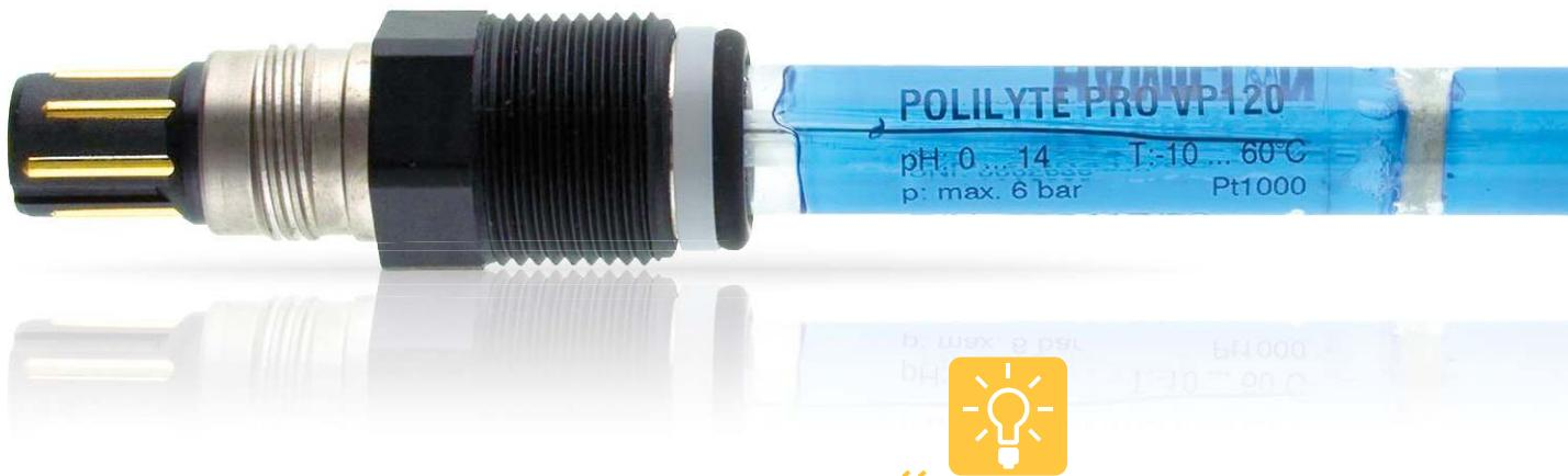
Не требующие технического обслуживания датчики Polilyte Pro и Polyplast Pro предназначены для измерения pH в процессах, связанных с водой, особенно в образцах с низкой проводимостью. Например, сточные воды, рыбоводство, грунтовые воды и т. д. Жидкостный контакт Single Pore гарантирует лучшие результаты измерений из-за прямого контакта между измеряемым образцом и электролитом Polisolve - засорение практически невозможно.
