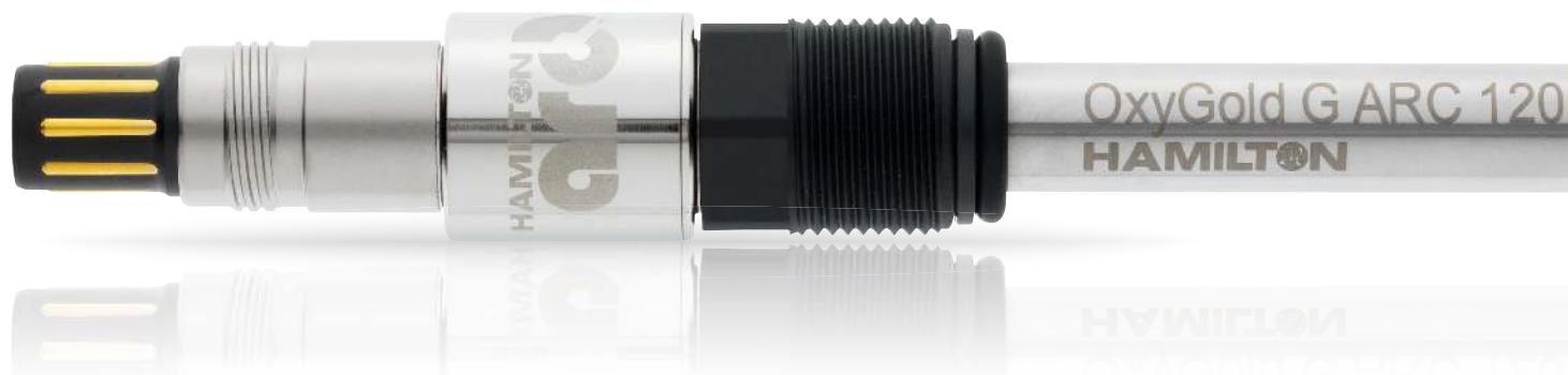
OxyGold G - это электрохимический кислородный датчик, предназначенный для процессов, в которых необходимо отслеживать очень небольшое количество кислорода. Например, в фармацевтической или микроэлектронной промышленности. Он также подходит для процессов, где присутствуют высокие давления.
