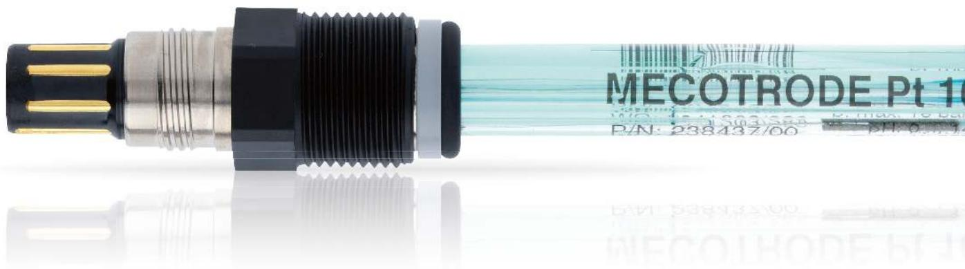
Не требующий технического обслуживания датчик MecoTrode предназначен для использования в химической промышленности с экстремальными значениями pH. Мембранные стекло типа Н обеспечивает низкую щелочную ошибку и стабильное измерение даже при высоких температурах.
