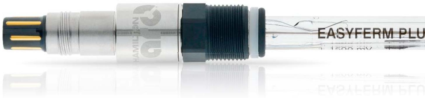
Датчики EasyPerm Plus ORP разработаны таким образом, чтобы работать в ответственных применениях в фармацевтической и химической промышленностях. Он имеет электролит под давлением, который предотвращает диффузию измеряемой жидкости в датчики. Картридж Everef-F гарантирует, что электролит системы сравнения Phermlyte не будет содержать серебра и осаждений.
