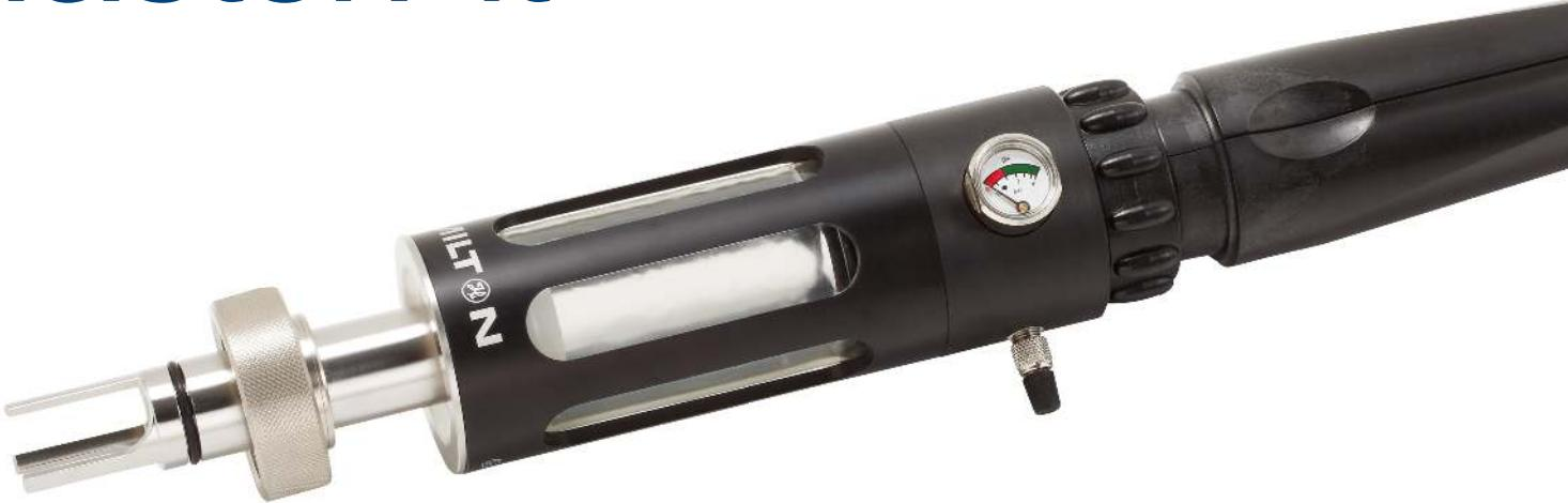
MasterFit - это корпус (арматура) для датчиков с поддавливанием электролита, таких как ChemoTrode. Поддавливание обеспечивает постоянный отток электролита. Это помогает предотвратить засорение диафрагмы и отравление электролита. MasterFit может использоваться в самых разнообразных применениях, в основном в химической промышленности.
