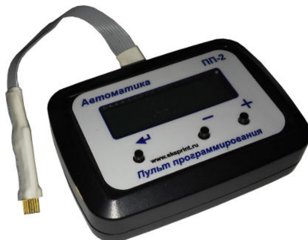
Рисунок 13 - Пульт программирования ПП-2
