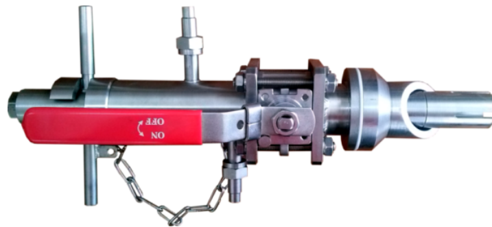
Рисунок 16 - Арматура АПН-4 для оперативной замены и промывки pH-электродов. Только разнесенное исполнение: корпус трансмиттера крепится отдельно от арматуры и соединяется с ней только кабелем
