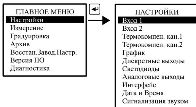
В меню устанавливаются параметры «Вход1», «Вход 2», «Термокомпенсация канал 1», «Термокомпенсация канал 2», «График», «Дискретные выходы», «Светодиоды», «Аналоговые выходы», «Интерфейс», «Дата и время», «Сигнализация звуком», «Очистка датчиков».
